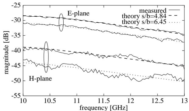
Fig. 8: MAGNITUDE OF COUPLING COEFFICIENT FOR SQUARE WAVEGUIDES WITH  $c/b=1$  AND SPACING  $s$  AGAINST FREQUENCY
