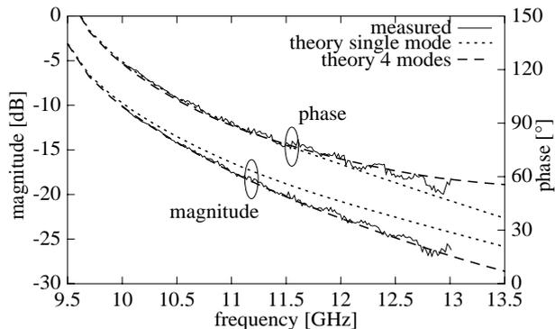
Fig. 5: REFLECTION COEFFICIENT AGAINST FREQUENCY
