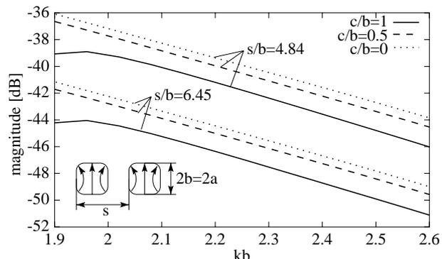
Fig. 7: H-PLANE COUPLING FOR IDENTICAL WAVEGUIDES AGAINST NORMALIZED FREQUENCY
