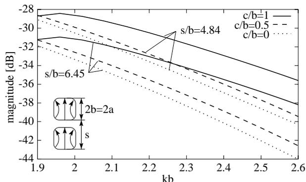
Fig. 6: E-PLANE COUPLING FOR IDENTICAL WAVEGUIDES AGAINST NORMALIZED FREQUENCY
